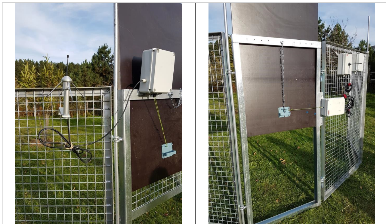
Figura 8.3: a sinistra meccanismo di sgancio mediante comando remoto Lo.Ra.; a destra meccanismo di sgancio attivato dagli animali mediante filo di inciampo non visibile nell'immagine (Materiali D.R.E.Am. Italia, foto Nicoloso)
