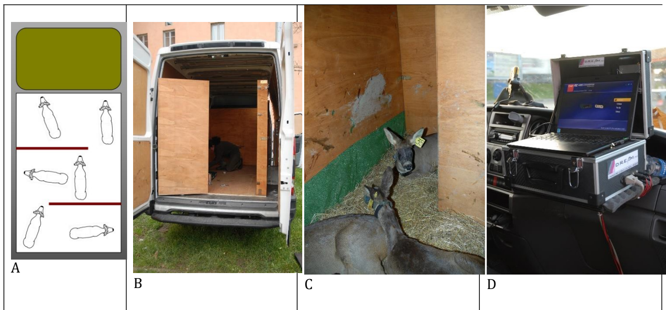
Figura 8.22: struttura temporanea per il trasporto di ungulati su furgone commerciale (A, struttura in pianta; B, allestimento della struttura in pannelli modulari; C, Caprioli durante il trasporto; D, monitor collegato con 4 telecamere per il monitoraggio degli animali durante il trasporto e la registrazione delle immagini) (foto: Nicoloso S.)
